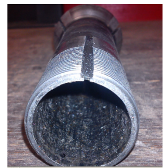
Die Nut muss in den kleinen Nutstein in der Aufnahmhülse finden
