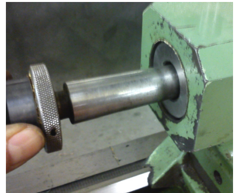
Bei ganz zurückgefahrener Pinole löst sich die Kegelklemmung
