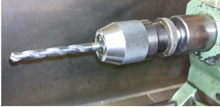
Bohrer kommen in ein Bohrfutter, große Bohrer direkt in die Pinole (Kegelaufnahme)
