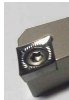
Schneidplatte im Detail
