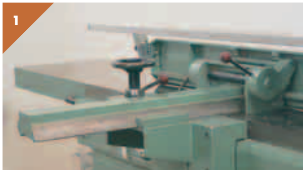
1 Anschlagführung ist gleichzeitig Messerwellenverdeckung
