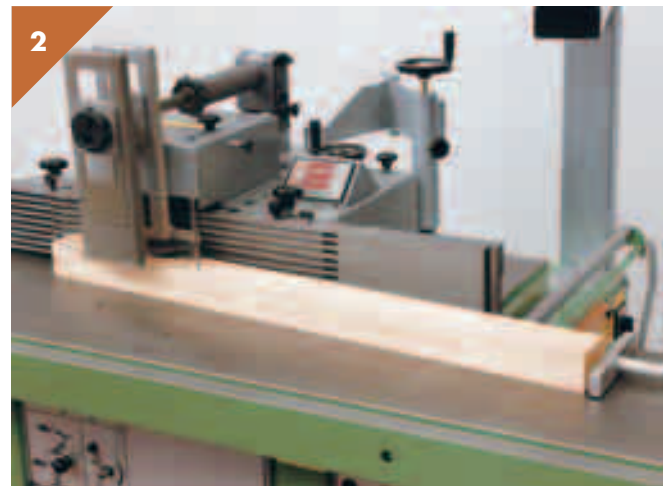
2 Rückschlagsicherung für Tischfräsmaschinen mit überlangem Tisch
