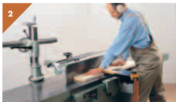
1 Bei verzogenen Werkstücken hohle (linke) Seite auf den Aufgabebisch legen.
