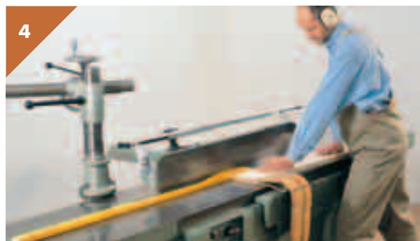
2+3+4 Zum Vorschub die Hände mit geschlossenen Fingern flach auf das Werkstück legen.
