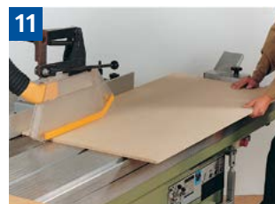
11 Schutzeinrichtungen und Handhaltung beim Einsetzsägen. Sägeblatt wird von unten nach oben durch das Werkstück angehoben.
