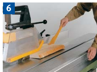
6 Sägen schmaler Werkstücke mit Schiebestock.
