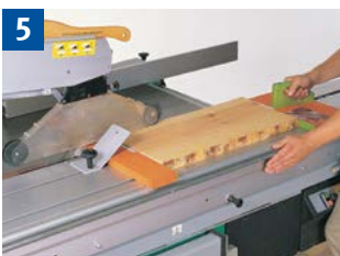
5 Vorrichtung und Handhaltung beim Besäumen.
