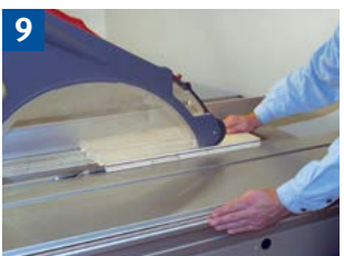
9 Schutzeinrichtung und Handhaltung beim Fälen.
