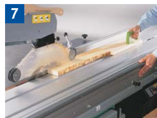
7 Sägen von Leisten mit Schiebeholz.
