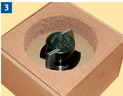
Werkzeuge mit Hartmetallwechschelschneiden immer in der Originalverpackung transportieren.
